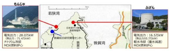
高速増殖原型炉もんじゅの廃止措置は、2022 年までが燃料体取り出し作業で、その後に ナトリウム機器の解体の準備作業に数年をかけるそうです。
